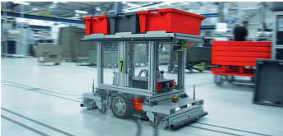
Der Logistikkassistent sorgt sowohl für die Materialbereitstellung als auch für die Unterstützung der Mitarbeiter in den Fertigungszellen
