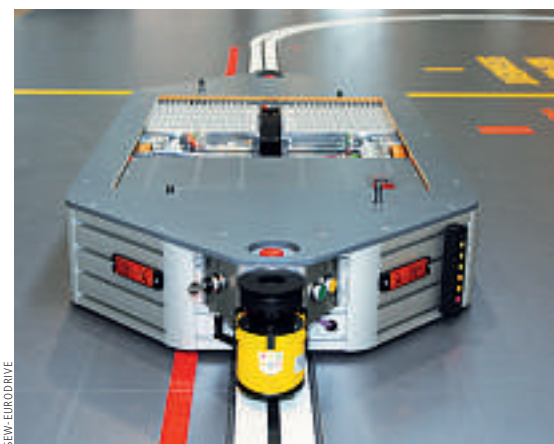
Die benötigte Energie wird über elektromagnetische Felder kontaktlos über einen Luftspalt auf die mobilen Verbraucher übertragen
