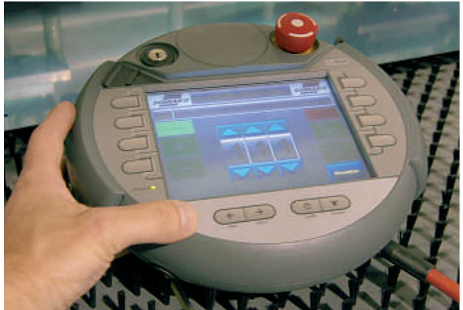
Bedienpanel der Steuerung für die komplexe Biegeanlage
