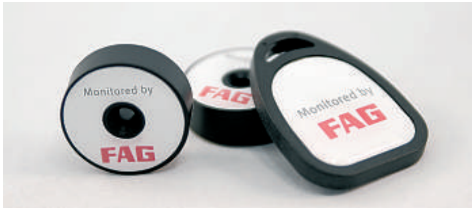
Optional erhältlich ist die Funktion der automatischen Messstellenerkennung mit RFID-Tags
