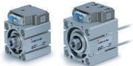
Der Kompaktzylinder CVQ mit integriertem Ventil senkt Druckverlust und Druckverbrauch, da keine Luftleitungen gelegt werden müssen
