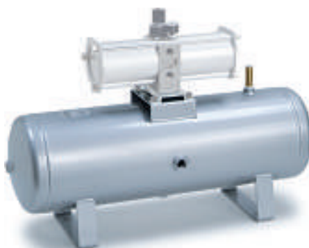
Der Druckverstärker der Serie VBA mit Drucklufttank erlaubt eine punktuelle Erhöhung des Drucks und hält den Netzdruck niedrig
