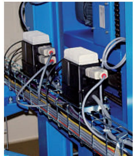
Dezentrale Motorstarter Mono-Switch und Duo-Switch sparen Installationszeit
