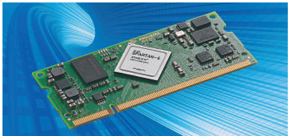
Auf die Automationsbranche optimiertes «Mars MX1»-FPGA-Modul, bei dem sich der Benutzer nicht um technologiespezifische Details kümmern muss
