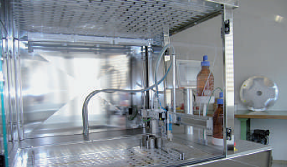
Die Linearachse LEF bringt bei diesem Anwendungsbeispiel einen Spraykopf in die richtige Position, um Werkstücke zu besprayen
