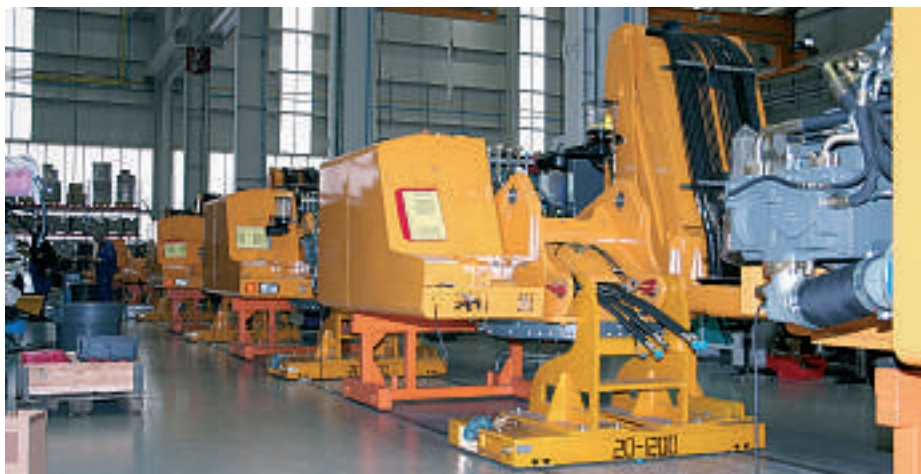
Die Transporttrolleys sind mit 150 mm Höhe sehr flach – tragen aber bis zu 80 t. Die Druckluftmotoren bieten mit bis zu 500 Nm ausreichend Drehmoment für den Antrieb
